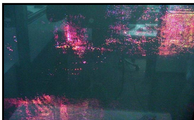
TV Plasma com sinal de Vsetup totalmente desajustado, impossibilitando a formação das imagens.
