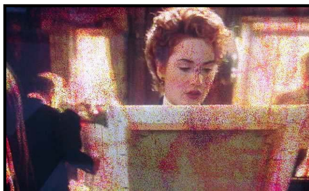
Imagem com granulações indicando que o sinal VSETUP deve ser ajustado.
