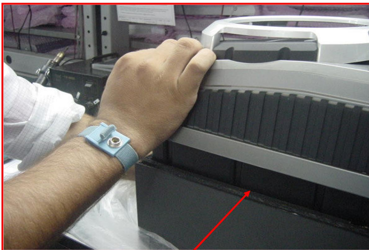
**Após o deslocamento efetuado de baixo para cima, a parte frontal estará desencaixada do gabinete traseiro.**
