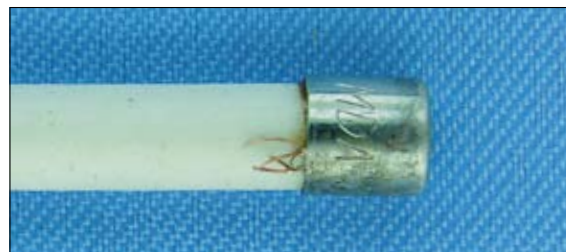
A Eletro Santana colocou um fusível com fios de cobre em seu interior.
