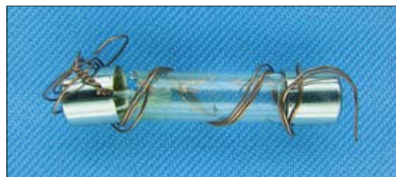
A Tatec enrolou um fio de cobre sobre o fusível original queimado.
