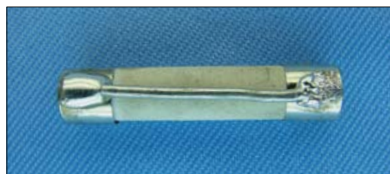
A Josemaq, que fez o reparo na hora, instalou um fusível já preparado, com fio de estanho soldado por cima.
