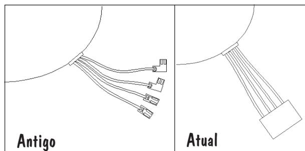
**OBS.:** Para a substituição em campo, manteremos somente o novo Motor do Ventilador com o conector quádruplo.
