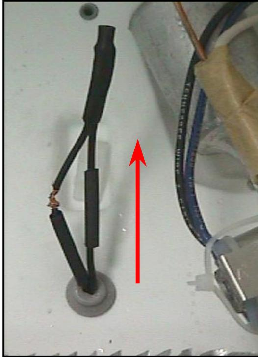
12- Com auxílio um de secador de cabelos ou com um Isqueiro, aqueça o Termo-Contratil de forma que ele faça a isolação entre os fios emendados e não permita a infiltração de umidade
