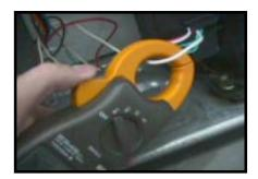
2.3- Ligue o produto e aguarde o Termômetro indicar no display que o Bimetal atingiu –10°C. Assim que o Termômetro indicar –10°C, desligue o produto da tomada e ligue-o novamente em seguida. (esta operação é necessaria para que o sensor envie para o módulo a informação que o produto esta frio, com temperatura abaixo de zero graus)
