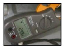
Corrente de produto 127V com Compressor e Ventilador ligados
