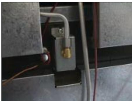
**Antes de reinstalar** o Tubo do Queimador do Grill, certifique que o Injetor esteja perfeitamente alinhado com seu eixo horizontal.
