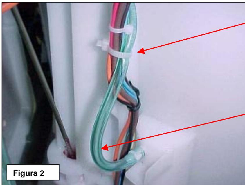
**Aperte-a com Força suficiente para que a Mangueira não deslize, passando a Cinta ao redor do Chicote.**
