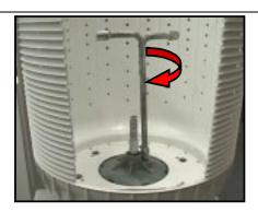
Para fixar a cunha no suporte, utilize o metodo **Pré-Torque**. Rosqueie o parafuso da cunha até que o mesmo encoste no suporte do cesto em seguida dê um giro de no **mínimo 180º** e de no máximo 270º
