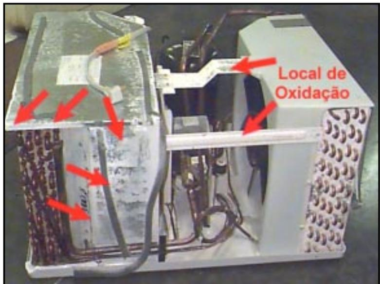
As regiões marcadas com setas nas fotos acima indicam os locais de Oxidação devido a ação química do Silicone, geralmente esta oxidação é na cor Branca, mas próximo dos tubos de Cobre ela aparece na cor Avermelhada.
