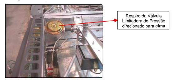
Para evitar entupimento do Respiro da Válvula, estamos girando a mesma em 180º para ele fique direcionado para baixo (conforme foto abaixo).
