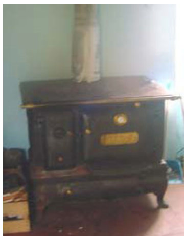
Figura 2: Fogões de ferro com repartimentos para lenha. Fonte: REGEDOR, Ana Flores. HENRIQUES, Sofia Teives. Energia no cotidiano: um olhar das nossas avós.
