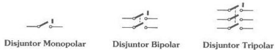
Figura 11 : Símbolos elétricos do disjuntor
