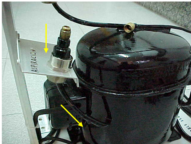
Detalle de la válvula de aspiración y del tubo de descarga sujeto con silicona para que no vibre, una mano de pintura a todo el conjunto, menos a las válvulas, mejorara su aspecto.
