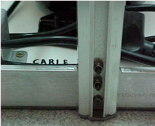
Detalle de la válvula de aspiración y del tubo de descarga sujeto con silicona para que no vibre, una mano de pintura a todo el conjunto, menos a las válvulas, mejorara su aspecto.
