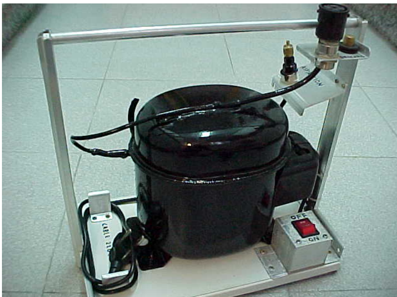
Detalle del interruptor ON/OFF y su carcasa, Realizado con chapas de aluminio.
