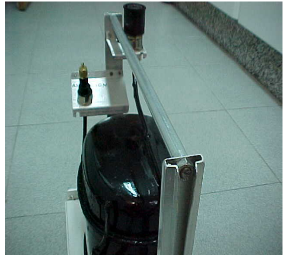
Detalle de la válvula de aspiración y del tubo de descarga sujeto con silicona para que no vibre, una mano de pintura a todo el conjunto, menos a las válvulas, mejorara su aspecto.
