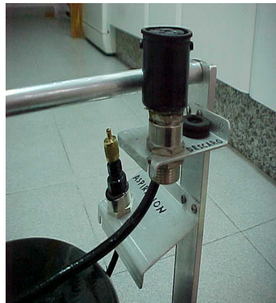
Detalle del soporte de la válvula de descarga, (salida del aire), con el filtro para evitar salpicar aceite.
