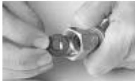
4. Coloque a **arruela de vedação** dentro da rosca interna da mangueira metálica.
