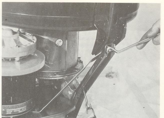
33- Com uma chave frisada de 1/2" remova as seis porcas que fixam o tanque aos três braços suporte (são duas porcas por braço).
