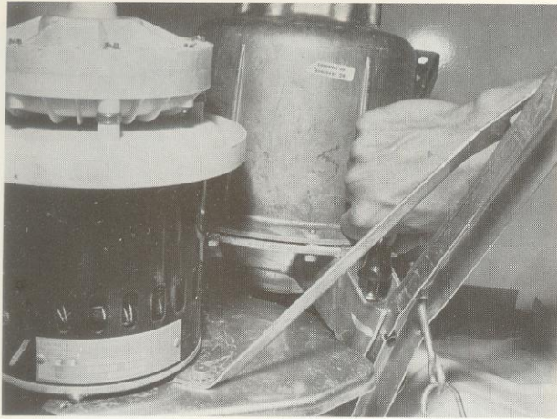
40- Com uma chave canhão de 1/2" remova os dois parafusos que fixam a base do motor à transmissão.
