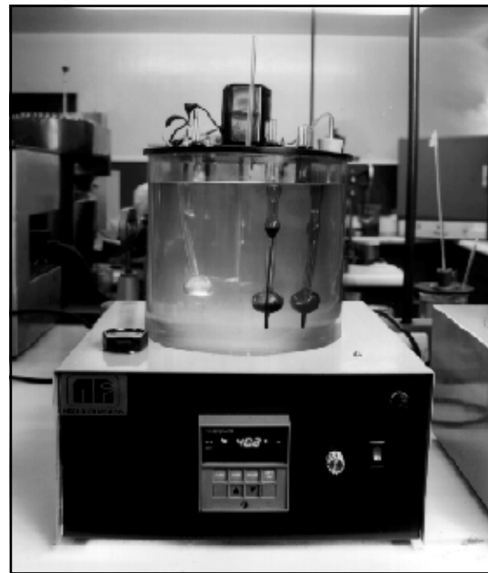
Figura 10.2 - Aparato utilizado para determinar la viscosidad cinemática.
