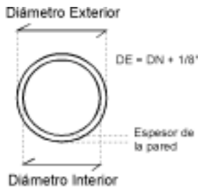
Figura 15.29 - Determinación del DE y DI de un tubo rígido.
