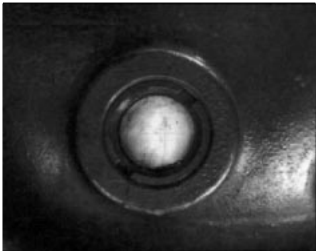
Figura 4.9 - Formación de espuma al arranque del compresor.
