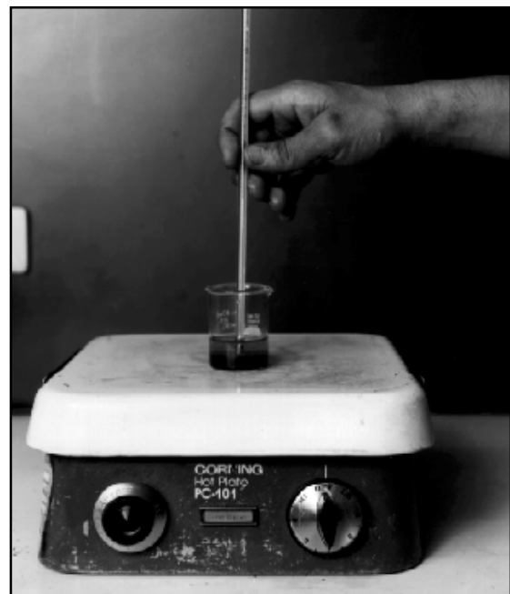
Figura 10.12 - Determinación del punto de anilina.
