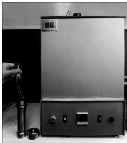
Figura 10.10 - Equipo para determinar el % de azufre en el aceite mediante la corrosión de una tira de cobre.
