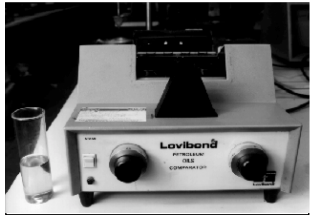
Figura 10.11 - Colorímetro utilizado para determinar el color ASTM.
