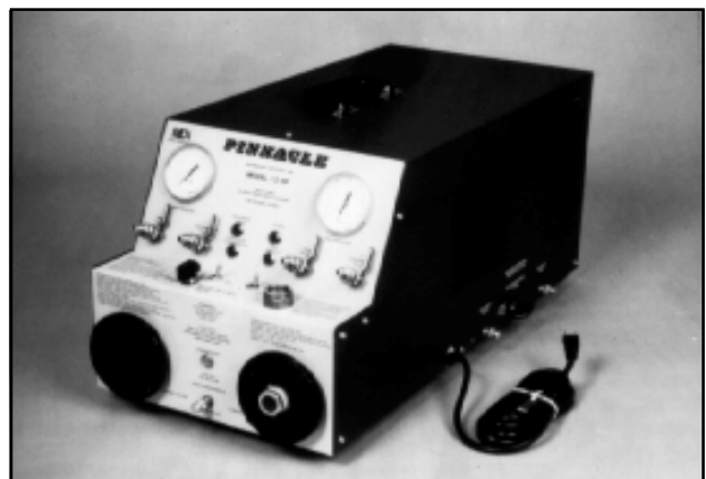
Figura 9.7 - Equipo para recuperación y reciclado de refrigerantes 12, 22, 500 y 502.
