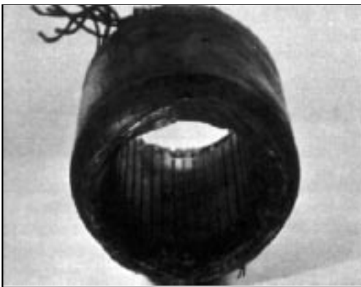
Figura 11.3 - Motor de un compresor semihermético que sufrió una quemadura completa.
