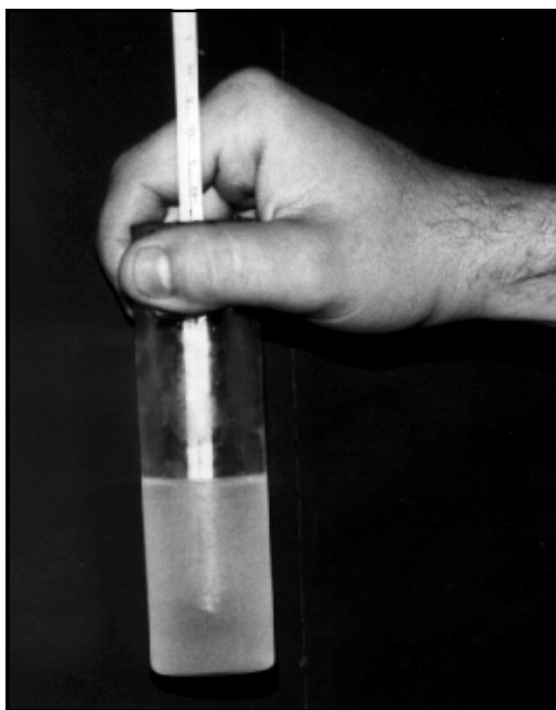
Figura 10.5 - Procedimiento para determinar el punto de floculación.
