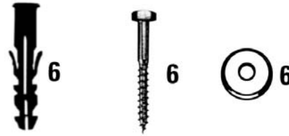
Bolsa fijación, contiene: 6 tacos Ø 10 x 60. 6 tornillos cabeza hexagonal Ø 8 x 50. 6 arandelas Ø 8 x 16.
