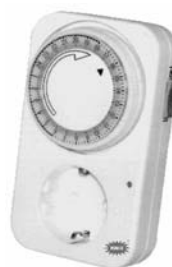
Programador diario mecánico 24 h. para enchufe 2P+TT lateral. Con pestaña 5393 extraíbles e interruptor ON/OFF. Max. 3500 W 16 amperios 230V.
