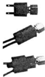
Presostato miniatura. Con rearme automático. a) P100 AA-3D. Long. cable 1,22m. Escala BAR Abre 10,3 Cierra 15,5. b) P100 AA-6D. Conex. Tipo Faston. Escala BAR Abre 2,4 Cierra 4,1.
