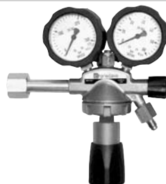
Manorreductor Nitrógeno CH770 hasta 50 bar. Normas EN-562 EN-585. Con válvula de seguridad y llave de corte. Toma de salida 1/4" SAE. protección de caucho en manómetros. Escala manómetros, alta de 0 a 315 bar. Baja de 0 a 60 bar.
