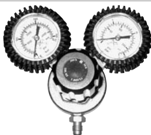
Manorreductor Nitrógeno LB-21 hasta 10 bar. Normas EN-562 EN-585. Con válvula de seguridad y llave de corte. Toma de salida 1/4 SAE. protección de caucho en manómetros. Escala manómetros, alta de 0 a 315 bar. Baja de 0 a 16 bar.
