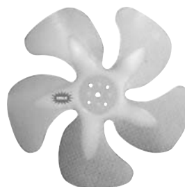
Hélice termoplástico, para ventilador. 254 mm 22° 10W. Mod. 4VEA008.
