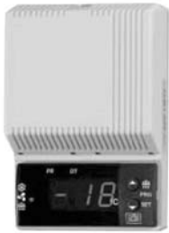
Termómetro termostato AK014610 -50 +99. 120 x 80 x 37 mm. 230V 50/60Hz Sonda NTC 1,50 m. (incluida). Relé R16 (4) A.
