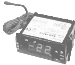
Termómetro termostato digital AKO TTDP-20B. -50 +99°C Alimentación: 230V 50Hz. Sonda 1, NTC de 1,5 m. Incluida calibrable. Relé 1 control (compresor) R16 (4) A. 250V COS 1, SPST.
