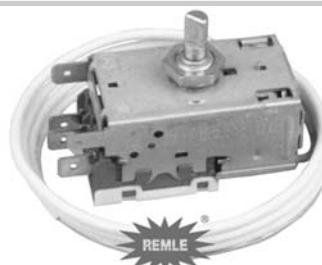
Termostato doméstico. Máxima (-26°/+5°) Mínima (-16°/+5°). Capilar 1000 mm. RANCO K59 L1035. Frigoríficos 2 puertas.
