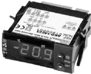
Termómetro termostato AK014223 -49,9 +999. Hueco de panel 70,5 x 28,5 mm. 230V 50/60Hz. Sonda NTC 1,50 m. (incluida) Relé R16 (4) A. Relé R8 (3) A. Entrada digital (para contactos libres de tensión).
