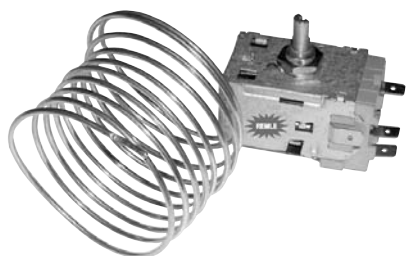
Termostato refrigerador con bulbo Combi. Máxima (-6/+4,5°) Mínima (-17°/+4,5°). Capilar 1700 mm. ATEA A130059.
