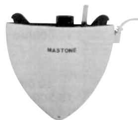
Bomba condensados MASTONE con depósito. Salida tubo de Ø 6x4. Depósito de 300 cm³. Elevación 2 metros. Capacidad 30 litros/hora. Indicador luminoso de funcionamiento. Potencia 10W.
