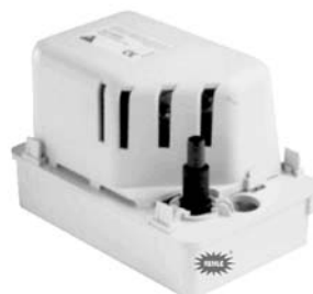
Bomba centrífuga monobloc con depósito para condensados. SAUERMANN Mod. SI1820. Caudal máximo 500 lts/h. Impulsión máx. 5,4 m. Potencia térmica 130°C • 230V 50/60Hz. Dimensiones: L195 x An130 x Al170 mm. Depósito: 2,0 litros.
