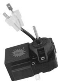
Motoventilador frigorífico. Giro horario. NO FROST. Ø Eje 4 mm. Longitud 20 mm. 220V 13W. CANDY, KELVINATOR.
