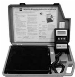
Báscula electrónica hasta 50 Kg. TIF 9010A. Resolución 2 g. Visualización Lbs/Oz/Kg. Dimensiones 387 x 267 x 63 mm. Funcionamiento con pila de 9V.
