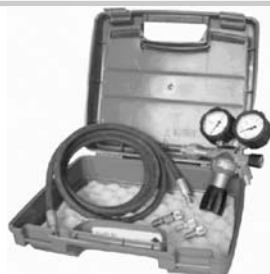
Conjunto pruebas nitrógeno, maletín con manguera,analizador, adaptadores y tapa organizador. 50bar 37 x 31 x 14 cm. a) Manguera 3 metros. Mod. CPN503. b) Manguera 5 metros. Mod. CPN505.
