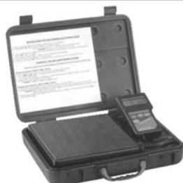
Báscula digital hasta 80 kg. Mod. GTA-80. Resolución 10 gr. Plataforma 23 x 23 cm. Auto-apagado a los 15 min. Funcionamiento con pila de 9V.
