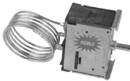
Termostato doméstico. Máxima (-19°/+3°) Mínima (-12°/+3°). Capilar 910 mm. ATEA C-19. Frigoríficos 2 puertas. PHILIPS.
