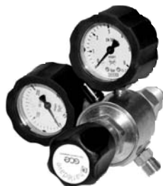
Manorreductor Oxígeno ST-101-OX. Manómetro entrada Ø 53 mm. De 0 a 315bar. Manómetro salida Ø 53 mm. De 0 a 16 bar. Presión de trabajo 0 a 7 bar.
