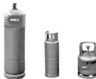
a) R-134 granel. Sustituto directo R-12. Cargar siempre en fase líquida. Utiliza aceite sintético, no mezclar con mineral. Aplicación: Refrigeración, automoción. b) R-134a granel.
