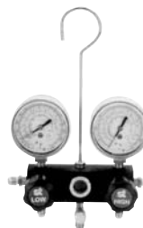
Analizador para H.F.C. Mod. ST 2002 A (sin mangueras) Manómetro alta y baja Ø 63. 2 válvulas. R-134A, R-404A. Conexión 1/4 SAE.
