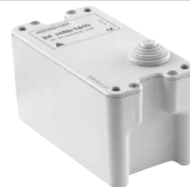
Bomba monobloc con depósito para condensados SAUERMANN. Mod. EE 1650. Caudal máx. 30L/h. Impulsión max.13m. 230V 50/60 Hz. 35W. Protección térmica 90°C. Dimensiones L160 x An85 x Al88 mm. Depósito 0,5 litros.
