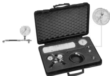
Conjunto prueba nitrógeno para sistemas Aire Acondicionado. Maletín compuesto: Regulador nitrógeno. Conexión 1/4 Sae. Presión salida: 0,5-45 Bares. Manómetro Ø80m Clase 10. Tubo flexible 1/4" Sae, 900+220mm. R410A. Adaptador 5/16" Sae-Fx1/4" Sae Macho.
