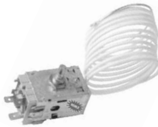
Termostato refrigerador. Máxima (-27°/+3°) Mínima (-13°/+3°). Rearme +3°. Capilar 2000 mm. ATEA A130270. Congelador Combi.
