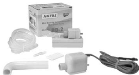
Bomba condensados. Mod. BD-2. 230V A 50Hz. Caudal máximo: 10 L/h. Elevación 2 metros.
