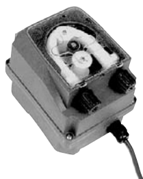
Bomba peristáltica SEKO. Pueden trabajar en seco. a) 3 litros/hora. Sin caja. b) 3 litros/hora. Con caja. c) 1/7 litros/hora. Regulable con caja.
