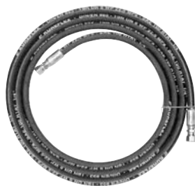
Manguera simple nitrogeno máximo 100bar. Longitud 3 m. Conexión tuercas locas hembras 1/4" SAE.
