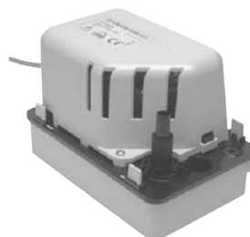
Bomba centrífuga monobloc con depósito para condensados. SAUERMANN Mod. SI 1805. Caudal máx.500L/h. 230V 50/60 Hz. 90W. Protecc. térmica 130°C. Impulsión max.5,4m. Dimensiones: L195 x An130 x Al122 mm. Depósito 0,5 litros.
