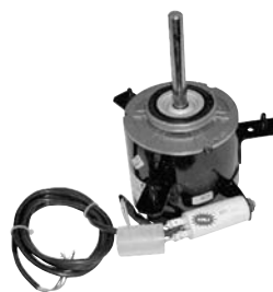
Motoventilador Unidad Exterior aire acondicionado. 3RGM. 4 polos condensador 4mF. Potencia 1000W 220V 0,95A. Longitud eje 90 mm. Eje 12,7 mm. Anclaje brida y tornillos (Distancia entre tornillos anclaje 135 mm.)
