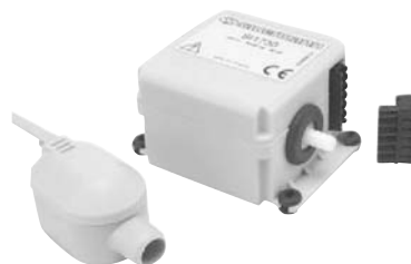
Bomba absorción condensados SAUERMANN. Mod. SI 1730. Caudal máx.30L/h. Aspiración max.2,5m. Impulsión máx.10m. 230V 50/60 Hz. 35W. Protecc. térmica 90°C. Dimens. bomba, 74x52x95mm. Dimens. detector, 55x40x35mm.
