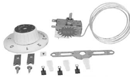
Termostato universal RANCO VW-8 . Máxima (+15°/+18°) Mínima (+15°/+34°). Capilar 1200 mm. Aire acondicionado de ventana, consolas.
