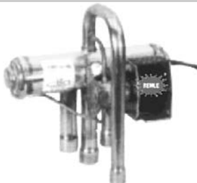
Válvula inversora 4 vías SAGINOMIYA . Refrigerantes: R407C, R22, R410A. a) Tipo: CHV-0101. Aspir. 3/8" Desc. 5/16". Capacidad 4,9 KW. b) Tipo: CHV-0201. Aspir. 1/2" Desc. 3/8". Capacidad 9,4 KW.
