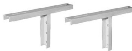
Soportes modelo REPISA. Pintado crema epoxi poliéster. a) Modelo PEQUEÑO. A = 400 B = 155. C164. b) Modelo MEDIANO. A = 460 B = 220. c) Modelo GRANDE. A = 500 B = 285. C165.
