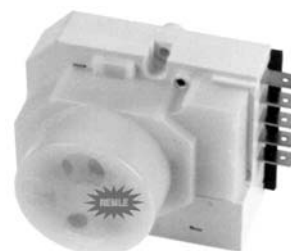
Temporizador descarche. Gama 87 al 94. NO FROST. Ciclos de 8,30 horas. Retardo 8 minutos. Mod. F-6562, 6563, RANCO T-25 L-5016. BOSCH, LYNX, SUPER SER.
