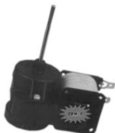
Motoventilador frigorífico giro horario. NO FROST. Ø Eje 4 mm. Longitud 45 mm. 220V 16,5W. SAN GIORGIO.
