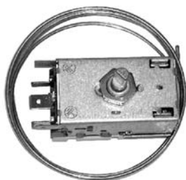
Termostato frigorífico 2 puertas. K59-L2541. -27 +4°C. Capilar 1200 mm. C.O. 383310CNK.
