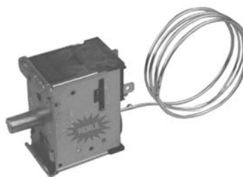
Termostato doméstico. Máxima (-20°/+3°) Mínima (-13°/+3°). Capilar 800 mm. ATEA 22-041-004. Frigoríficos 2 puertas. AGNI, CORCHO, PHILIPS.
