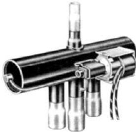
Válvula 4 vías RANCO , R-22. a) Mod. V2-308060-200. 1/2" 3/8". Mín. 2,6 Kw. Máx. 8,8 Kw. b) Mod. V2-308060-400. 5/8" 3/8". Mín. 2,6 Kw. Máx. 8,8 Kw.
