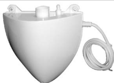
Bomba condensados. Mod. BD-1. 10W 220V. Depósito agua 300 cc. Elevación 2,5 metros. Longitud cable 110 cm.
