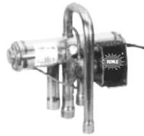
Válvula inversora 4 vías SAGINOMIYA . Refrigerantes: R407C, R22, R410A. a) Tipo: CHV-0301. Aspir. 8/8" Desc. 1/2". Capacidad 11,3 KW. b) Tipo: CHV-0401. Aspir. 3/4" Desc. 1/2". Capacidad 21,2 KW.
