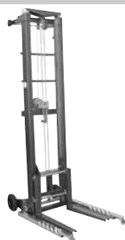
Carretilla elevadora manual C-800. Altura máx. con pala posición normal 3330 mm. Invertida 4000 mm. Carga máx. elevable 160 kg. Carga mín. 25 kg. Peso 70 kg. Ancho 650 mm.
