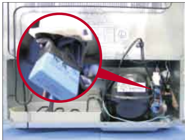
A GE usa fita isolante como luva para fixar o capacitor.
