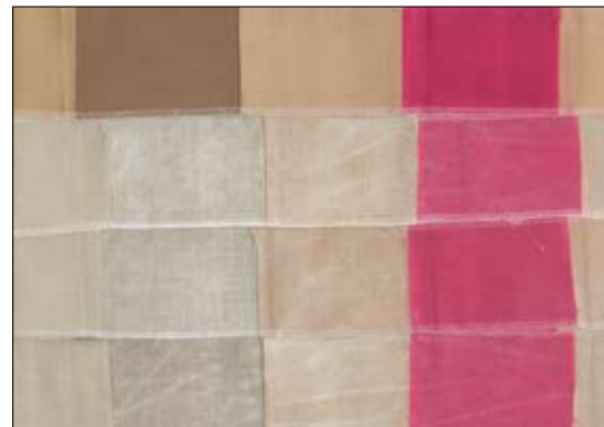
Para avaliar a lavagem, foram costuradas tiras com manchas padronizadas nas peças colocadas nas máquinas.
