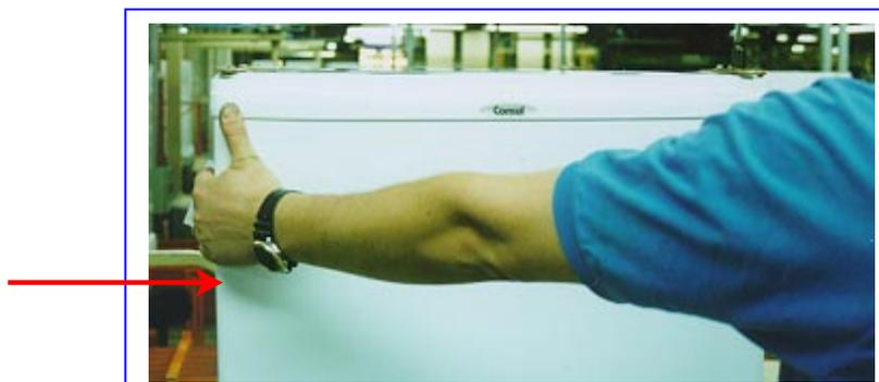
6. Coloque a Dobradiça Superior e reaperte-a, verificando o contato entre a Gaxeta e a Flange do Gabinete
