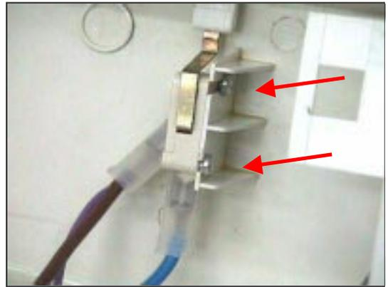
**Figura 2 Fixação da micro chave**
