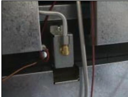
**Antes de reinstalar** o Tubo do Queimador do Grill, certifique que o Injetor esteja perfeitamente alinhado com seu eixo horizontal.
