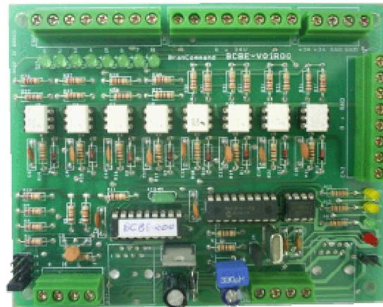
Os módulos de I/O - Entrada e Saída, são distribuídos e se comunicam via rede de comunicação CANBUS. Para os módulos se comunicarem entre si e com a IHM, é necessário interligá-los ao módulo de comunicação BC-CAN.
