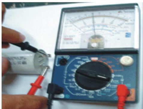
Para testarmos um capacitor utilizamos um capacímetro ou [multímetro](#) analógico conforme mostra imagem Á cima na escala de resistência ôhmica, utilizando uma ponta de prova para cada terminal.
