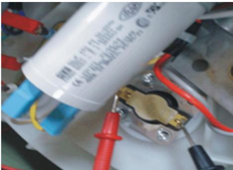
Localiza-se no fundo do tanque da lavadora, preso a resistência. O termostato abre a 55°, desligando a resistência. Para testar esse componente, verifique continuidade entre seus terminais.
