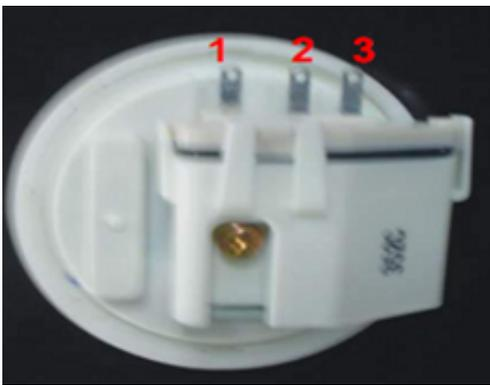
O pressostato eletrônico é acionado pela pressão da água e controla os níveis de água: extra-baixo, baixo, médio e alto pela variação de resistência ôhmica, informando a placa eletrônica de acordo com o nível selecionado.
