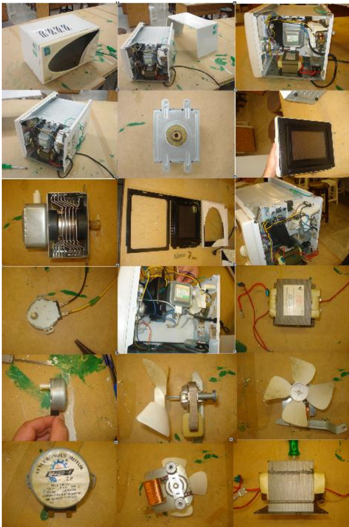
Imagem 20 – Como funciona o micro-ondas:Componentes internos Autor: BURDA, Roger José Mafra
