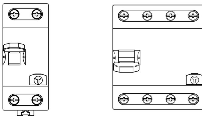
Para verificar se o dispositivo DDR e/ou IDR está instalado e em perfeito funcionamento, acione o botão “teste”.
