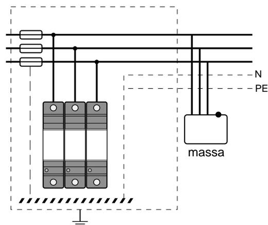
Os dispositivos de proteção contra sobretensões devem ser instalados depois do dispositivo de seccionamento (o disjuntor, por exemplo), mas antes do dispositivo DR.
