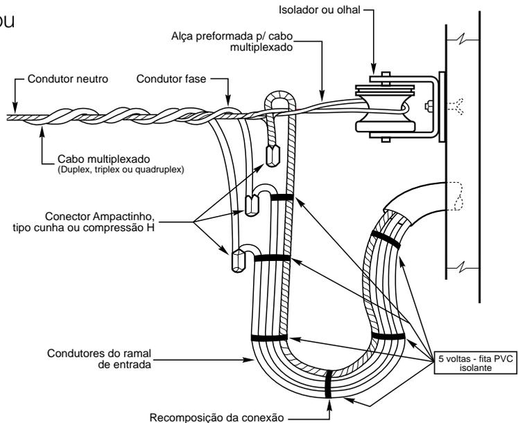
**NOTA:** O que determina se a unidade consumidora será atendida por 2, 3 ou 4 fios, será em função da carga (kW) instalada. As Normas referenciadas anteriormente neste subitem 2.1, estabelecem os procedimentos que deverão ser seguidos.
