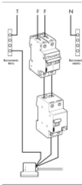
Como foi visto no subitem 4.4 página 97, a Norma NBR 5410/97 **só permite** o seccionamento do condutor Neutro em determinadas situações. A utilização de DR é uma dessas situações. O condutor Neutro e os condutores Fase são seccionados na entrada de alimentação do DR, sendo que devem ser restabelecidos juntamente, na saída do DR. Deve-se notar que os condutores Neutro e Fases são seccionados e restabelecidos, simultaneamente.
