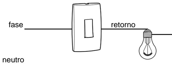
O esquema para a ligação elétrica deverá ser:
