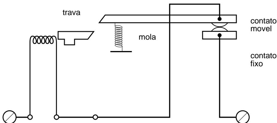
A combinação desses dois disparadores, protege o circuito elétrico contra correntes de alta intensidade e de curta duração, que são as correntes de curto-circuito (disparador magnético) e contra as correntes de sobrecarga (disparador térmico).
