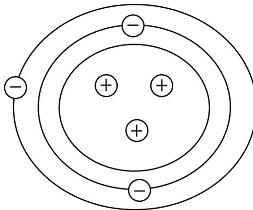
Em um átomo, o número de Elétrons é igual ao número de Prótons, sendo portanto, o átomo eletricamente neutro, pois a soma das cargas dos Elétrons (negativas) com as cargas dos Prótons (positivas) é igual a zero.
