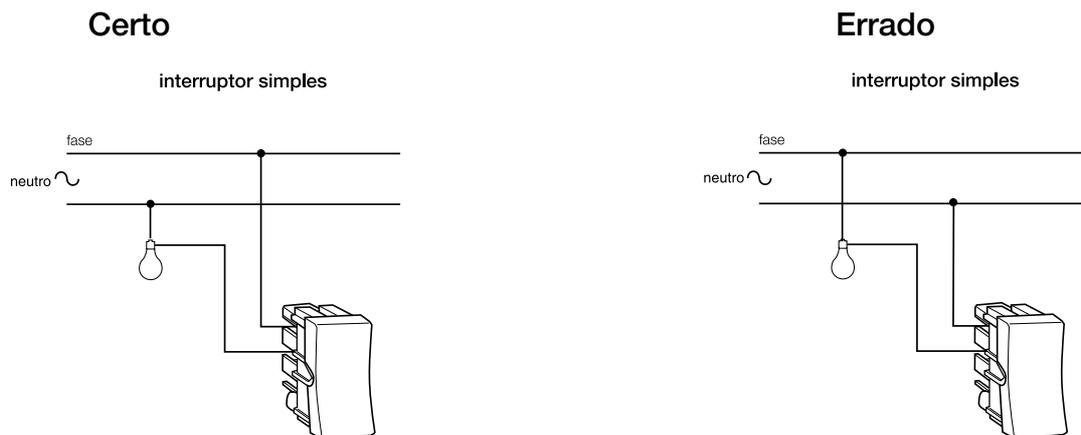
Observação: O condutor Neutro deve ser **sempre** ligado em um ponto (ou polo) do Receptáculo (ou porta-lâmpada) da luminária e o Condutor Fase em um ponto Interruptor. O Condutor Retorno sai do outro ponto do Interruptor, indo até ao outro ponto Receptáculo, completando assim, o circuito elétrico.
