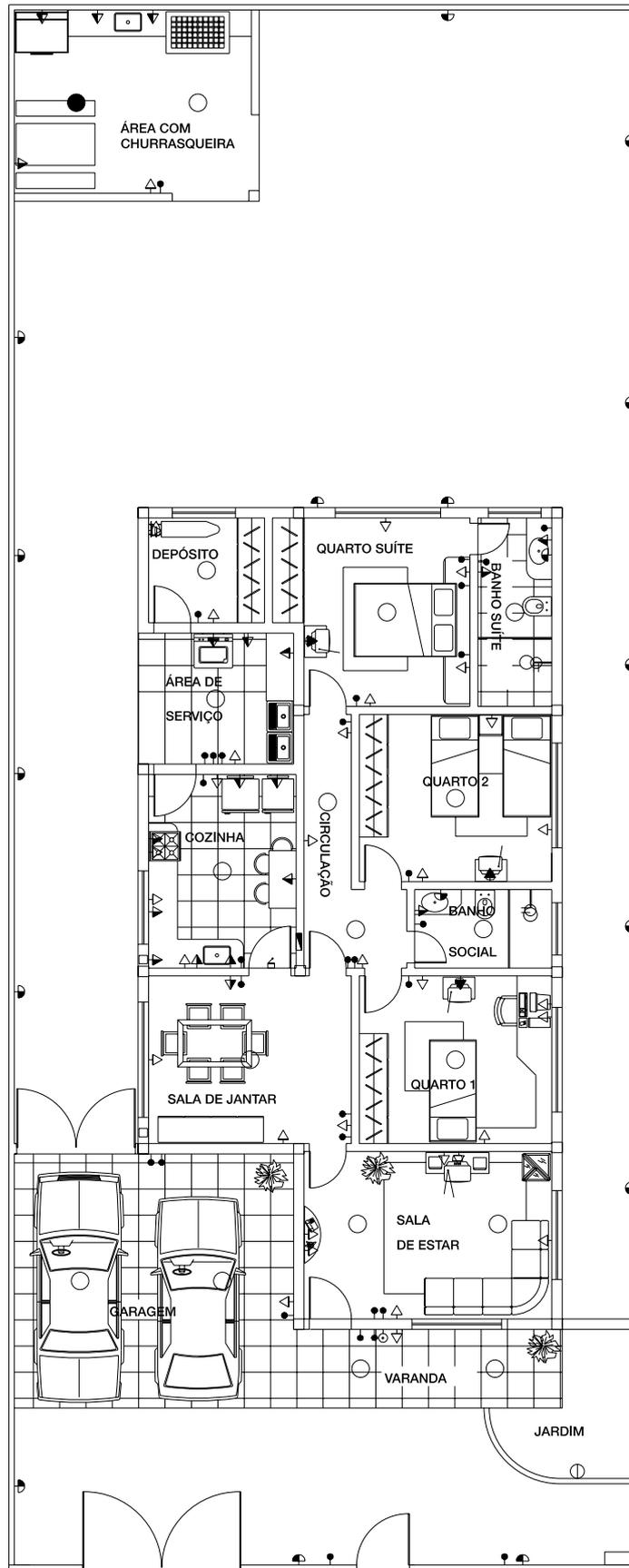
3 – Planta com os pontos de iluminação, interruptores, tomadas de uso geral e tomadas de uso específico:
