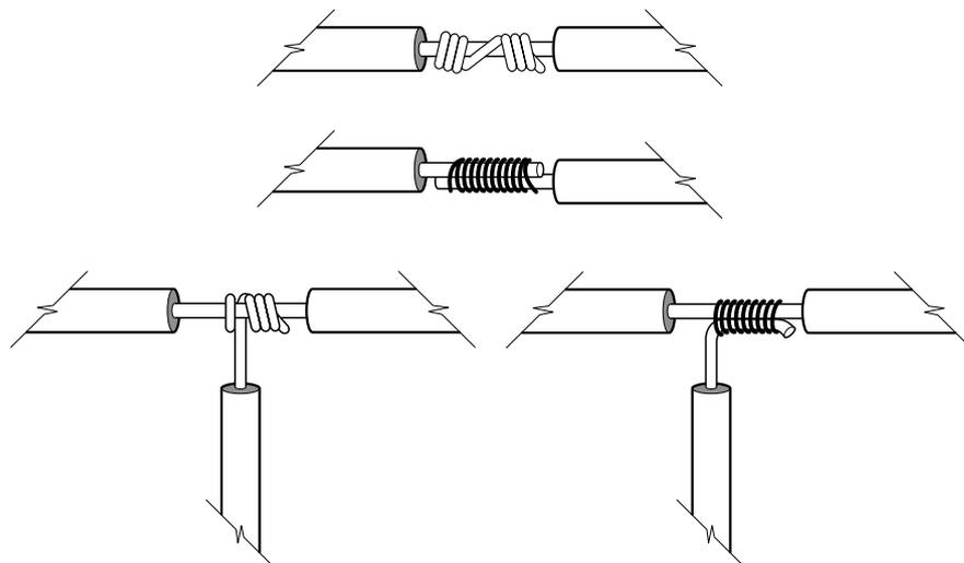
Em ambos os casos, recomenda-se cobrir a emenda com solda, a fim de garantir uma perfeita continuidade elétrica ao circuito. Para ligação de aparelhos com cordões flexíveis, deve-se usar um nó de segurança nas extremidades do condutor, a fim de evitar que qualquer esforço mecânico efetuado sobre o condutor seja transmitido aos contatos elétricos.
