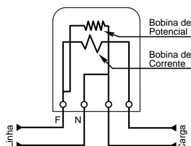
Um disco colocado junto ao núcleo, que por força dos campos magnéticos formados (da tensão e da corrente), quando a carga está ligada, passa a girar com velocidade proporcional à energia consumida. Através de um sistema de engrenagens, a rotação do disco é transportada a um mecanismo integrador.
