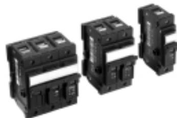
Deve-se ressaltar que a função do disjuntor, neste caso, é proteger a instalação, e não as cargas instaladas. Assim a corrente do mesmo, nunca poderá ser superior à corrente máxima admissível para o condutor do circuito elétrico.
