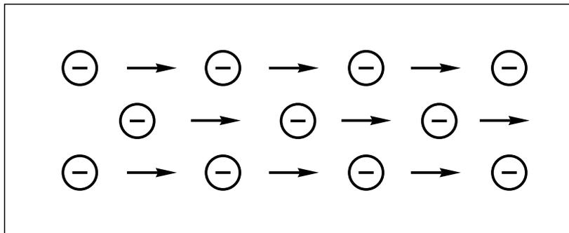
O movimento ordenado de elétrons, provocado pela tensão elétrica, forma uma corrente de elétrons. Essa corrente de elétrons é chamada de Corrente Elétrica (I). Sua unidade de medida é o Ampère. O símbolo desta unidade é A. Exemplo: Corrente elétrica de 10 A (Ampères).
