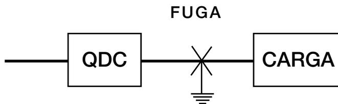
Por exemplo, se numa instalação acontece uma “fuga” de corrente entre a proteção e a carga, a corrente de “fuga” se somará à corrente de carga, podendo fazer com que o dispositivo de proteção atue, desligando o circuito elétrico.
