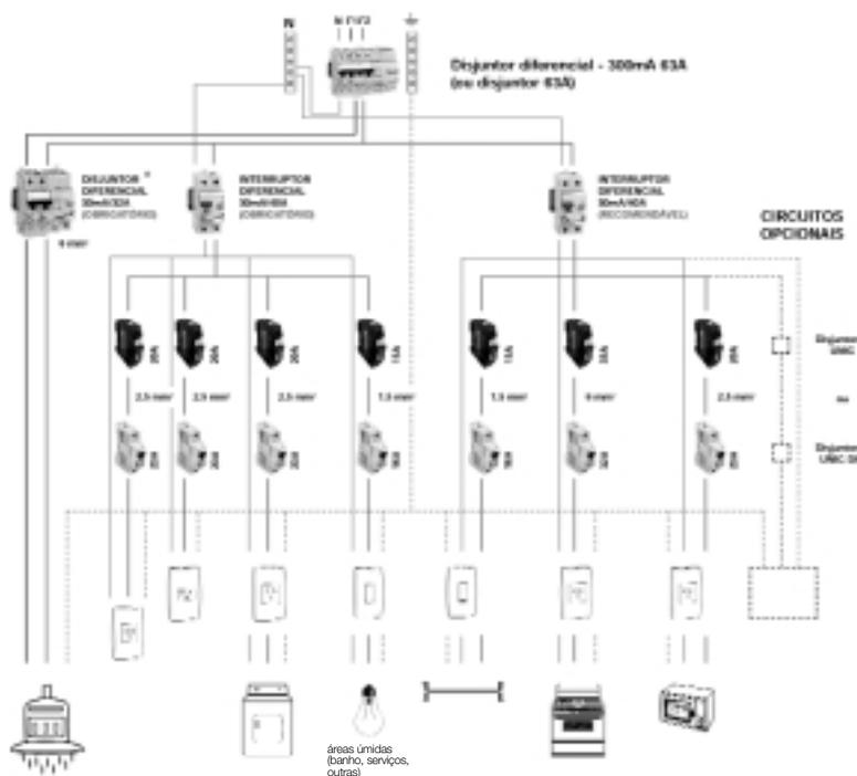
As seções nominais dos condutores e as correntes nominais dos disjuntores, disjuntores diferenciais e interruptores diferenciais residuais devem ser dimensionadas conforme prescrito na norma de instalações elétricas de baixa tensão NBR 5410
