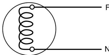
Nos geradores monofásicos de corrente alternada, um dos terminais deste Gerador é chamado de Neutro (N) e o outro de Fase (F).
