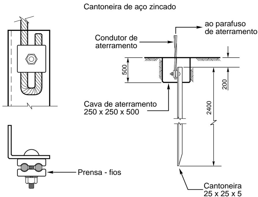
Todo Aterramento elétrico tem um valor de Resistência (ohms). O valor da resistência do Aterramento é muito importante. Quanto menor o valor, é melhor, pois aumenta a segurança – a corrente elétrica de falta escoar para a terra com mais facilidade. Para isso, deve seguir os procedimentos sobre os aterramentos nas Normas vigentes da CEMIG, bem como a Norma vigente NBR 5410/97.
