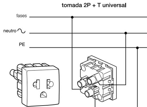
É importante salientar que na Tomada de 3 (três) pólos, os fios do circuito de tomadas da instalação elétrica, devem ser ligados desta forma:
