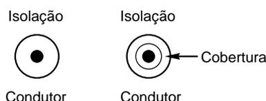
A camada de isolação de um condutor, pode ser de compostos termoplásticos como o PVC (Cloro de Polivinila) ou por termofixos (vulcanização) como o EPR (Borracha Etileno-propileno) e o XLPE (Polietileno Reticulado) etc.
