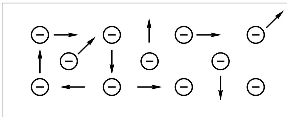
Para que estes elétrons se movimentem de forma ordenada nos fios, é necessário ter uma força que os empurre. Essa força é chamada de Tensão Elétrica (U). Sua unidade de medida é o Volt. O símbolo desta unidade é V. Exemplo: Tensão elétrica de 127 V (Volts).
