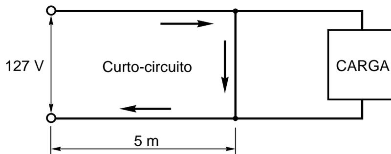
No circuito acima, se a instalação fosse feita com fio de  $0,5 \text{ mm}^2$ , cuja resistência elétrica é
