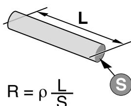
Diagrama de um condutor cilíndrico com comprimento  $L$  e seção transversal  $S$ . A fórmula da resistência elétrica é dada por:
