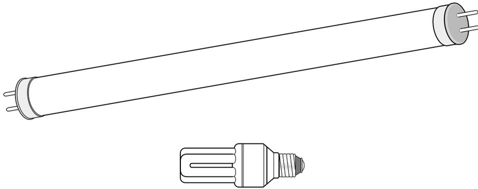
Essas lâmpadas fluorescentes necessitam para funcionar de um equipamento auxiliar, denominado de Reator. Ele é necessário para produzir a sobretensão necessária ao início da descarga e para limitar a corrente.
