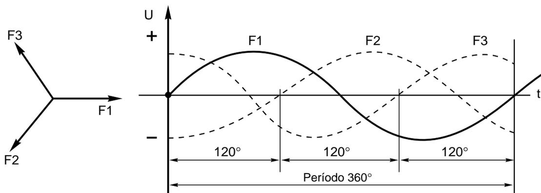
Neste circuito trifásico com a ligação em Estrela, as relações entre as tensões elétricas, a tensão entre Fase e o Neutro ( $U_{FN}$ ) e a tensão entre Fases ( $U_{FF}$ ), são:
