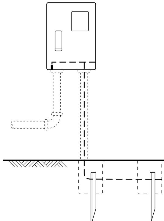
A partir do QDC, o Condutor de Proteção (PE), deverá ser derivado para os circuitos elétricos: de tomadas e de equipamentos de uso específico (chuveiros elétricos, fornos elétricos, etc), ou outro circuito elétrico que seja necessário o aterramento de equipamentos. Ver itens 4.4.1 página 97 e 4.4.2 página 99.
