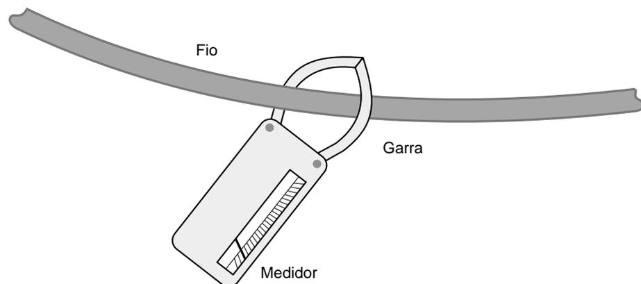
Observação: O amperímetro deverá abraçar apenas o(s) fio(s) da mesma Fase ( $F_1$ ,  $F_2$  ou  $F_3$ ).
