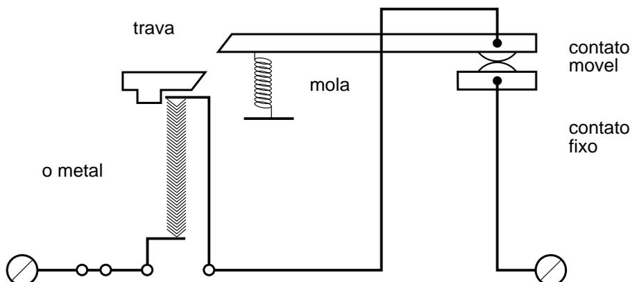
**b) Disparador magnético contra curtos-circuitos** - é formado por uma bobina (tubular ou espiralada) intercalada ao circuito, que ao ser percorrida por uma corrente de curto-circuito, cria um campo magnético que atrai a armadura, desligando instantaneamente o disjuntor.
