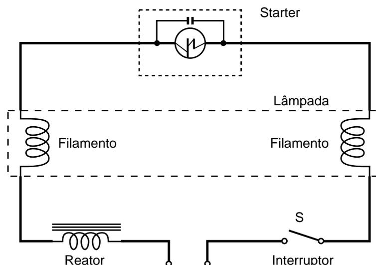
Ao ser fechado o interruptor S, o “Starter” fecha e abre rapidamente. Quando ele está fechado os filamentos são aquecidos ionizando o vapor de mercúrio (gás) existente dentro do tubo e ao abrir é dada a partida na lâmpada, ou seja, passa a circular corrente entre os filamentos e a Lâmpada emite a luz. Depois que a Lâmpada está acesa, “pode-se retirar” o “Starter” do circuito, uma vez que não circula corrente pelo mesmo.
