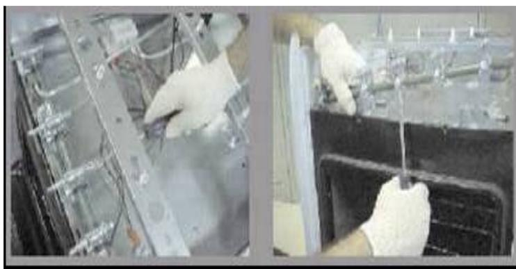
Figura 14: Remoção dos injetores e registros de GLP e montagem dos injetores e registros para GN.
