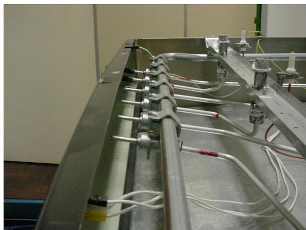
Figura 5: Registros montados sob pressão no tubo de gás principal
