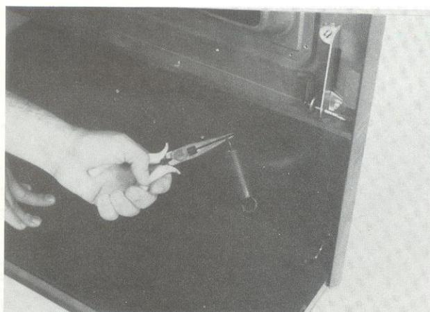
13- Utilizando um alicate de bico, remova as duas molas da dobradiça da porta do forno.
