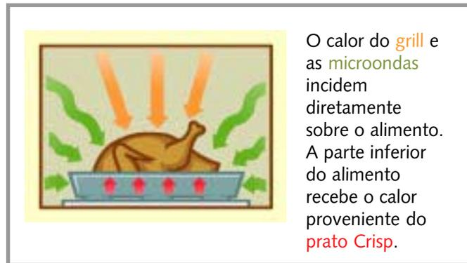
O calor do grill e as microondas incidem diretamente sobre o alimento. A parte inferior do alimento recebe o calor proveniente do prato Crisp.
