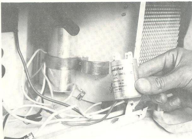
45 - Remova o capacitor do motor ventilador.
