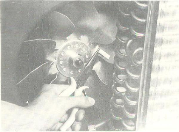
13 - Utilizando um alicate de bico remova as três presilhas fixadoras da câmara do condensador.
