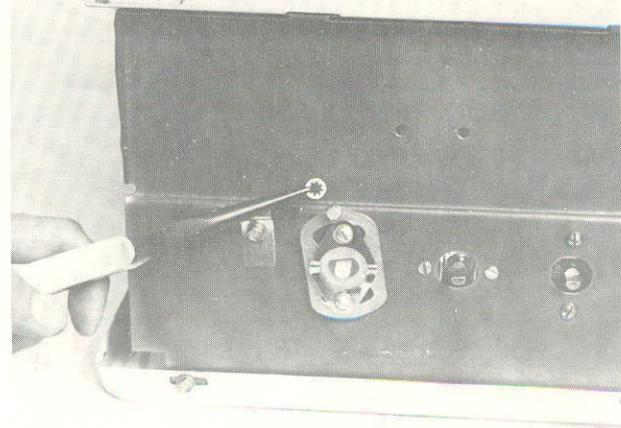
14 - Utilizando um alicate de bico remova a arruela dentada fixadora do cabo de aço
