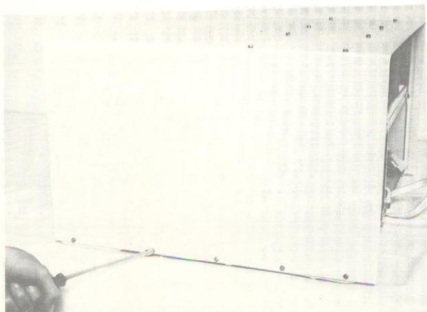
7 - Utilizando uma chave canhão de 1/4" remova os vinte parafusos fixadores do gabinete.
