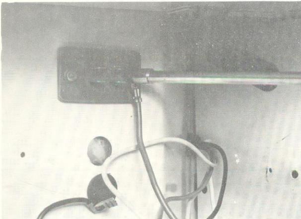
49 - Utilizando uma chave canhão de 1/4" remova o parafuso fixador do fio terra do cordão de entrada.
