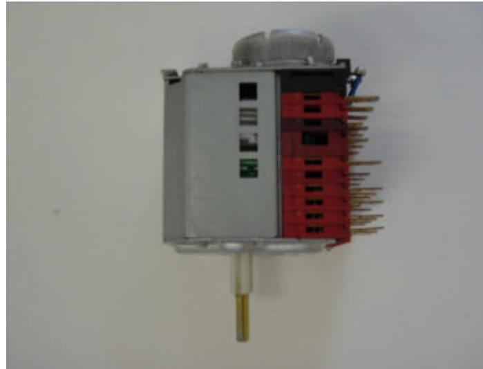
Este componente é responsável por todas a programação da máquina, abrindo e fechando contatos conforme a operação que está sendo executada.
