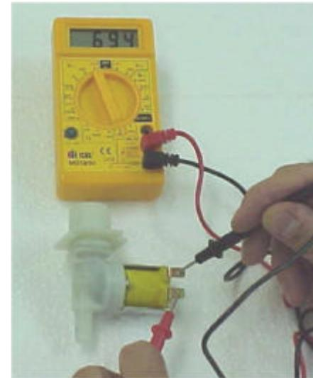
Componente eletromecânico que possui bobina, núcleo de ferro e um diafragma, localizada na parte traseira a válvula tem a função de permitir a entrada de água quando energizada, assim que é desenergizada o núcleo é retraído cortando a passagem de água.
