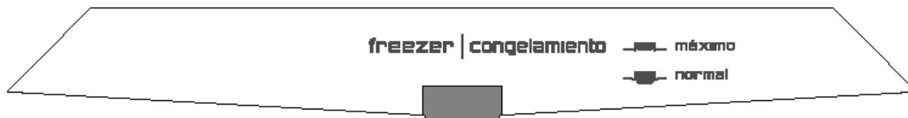
Permite al consumidor que seleccione la temperatura deseada del Freezer en 2 niveles, de normal para máximo y viceversa, siempre a cada toque en el botón.
