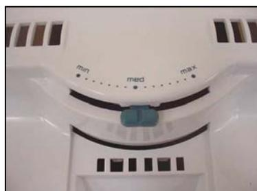
El Compartimiento Refrigerador posee un control independiente de temperatura que es realizado por un Damper Termostático (que controla el flujo del aire frío), con 3 graduaciones; mínimo, medio y máximo.
