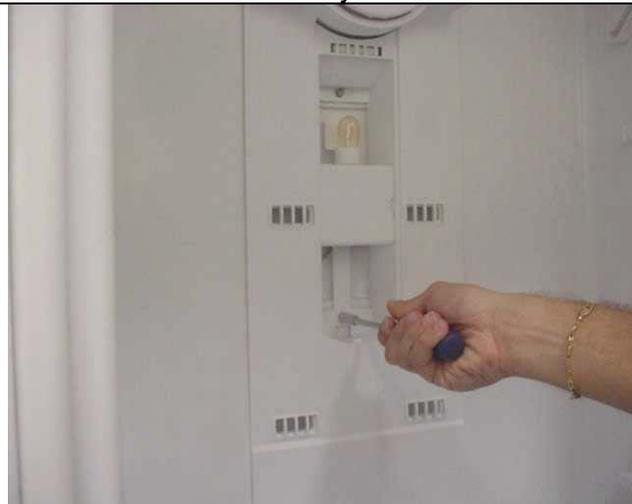
4- Desencaje del techo y suelte los conectores.
