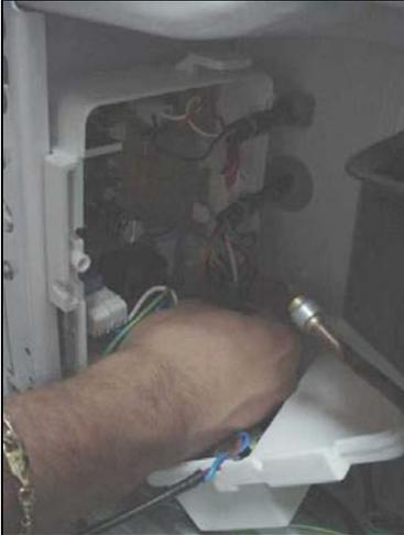
4. Suelte los demás tornillos y retire la Unidad de Control.
