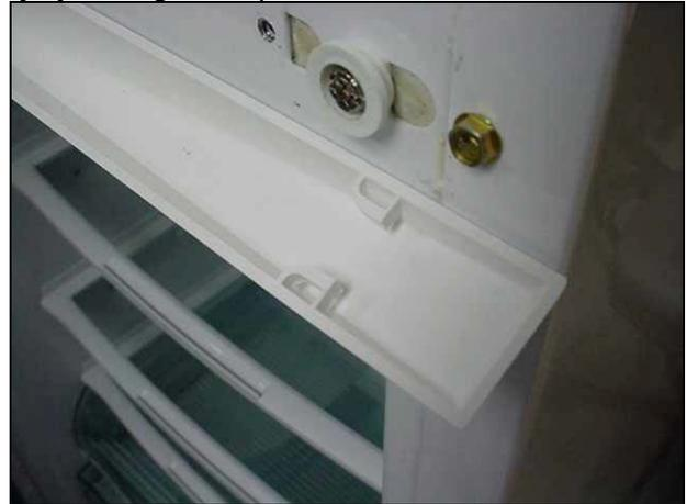
Nota: Para esta operación deslice la consola por la bisagra por el lado izquierdo y encájelo en el buje por el lado derecho
