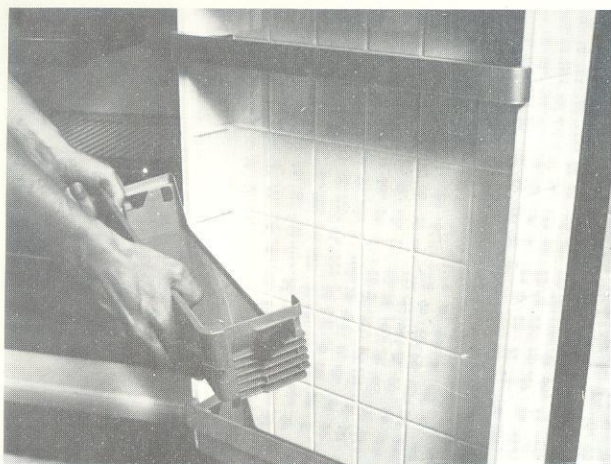
A - Com o combinado desligado, remover todas as prateleiras da porta.
