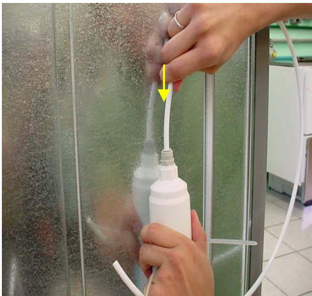
6) Agora na outra ponta que sobrou da mangueira encaixe o pino dourado com a parte dobrada para fora, o estrangulador de plástico com a cunha voltada para fora, e a rosca de fixação. Depois empurre a rosca dourada de modo que ela prenda o estrangulador no pino, todo este conjunto prenderá a mangueira e garantirá a perfeita conexão na válvula de água do Side by Side.
