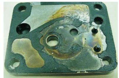
Carbonización y degradación de partes metálicas
