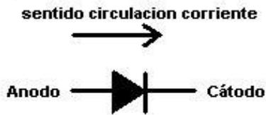
El diodo es como una válvula de agua, deja pasar corriente (agua) en un solo sentido, de ánodo a cátodo, impidiendo que circule al revés. Este es el circuito rectificador más sencillo. Pero la corriente obtenida no es pura, hay rizado, o sea, restos de alterna.
