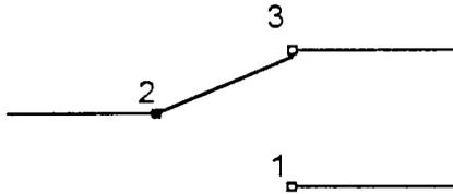
Desconecta 2-3 con la disminución de la temperatura, conectando 1-2.
