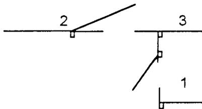
Desconecta 2-3 con la disminución de la temperatura. La llave auxiliar desconecta sólo en posición "OFF"
