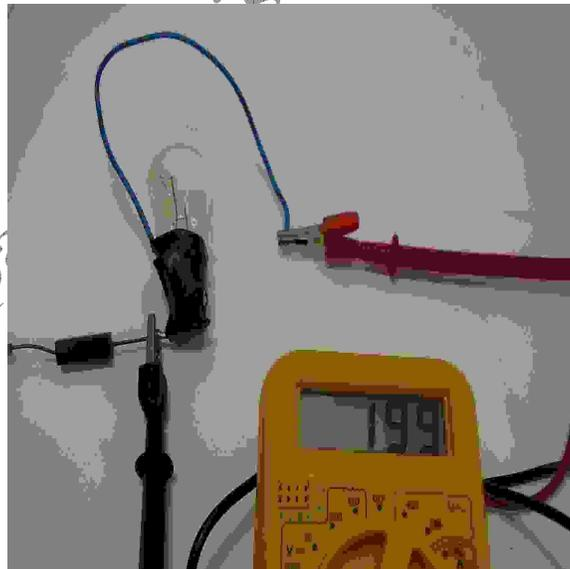
**Medida correcta en polarización directa, con un alimentador de 14,9 V**
