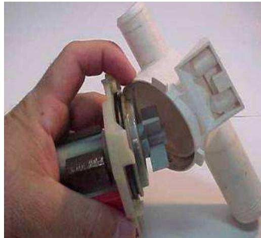
Un problema muy común es que se suelte y saque el rotor para limpiarlo y no se coloque la junta correctamente lo que produce la avería antes descrita de entrada de agua y jabón. Aquí vemos un ejemplo.
