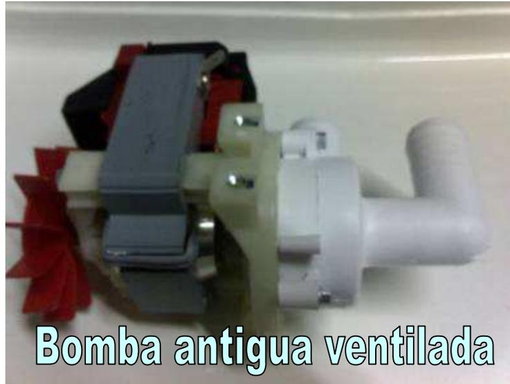
Está fabricada con un rotor metálico y un estator con núcleo metálico y bobinado interior muchísimo más grueso y robusto que los modelos de la página anterior. Están autoventiladas y disponen de 6 posibles colocaciones distintas y potencias muy diferentes dependiendo del modelo pero rondando los 50w la gran mayoría.
