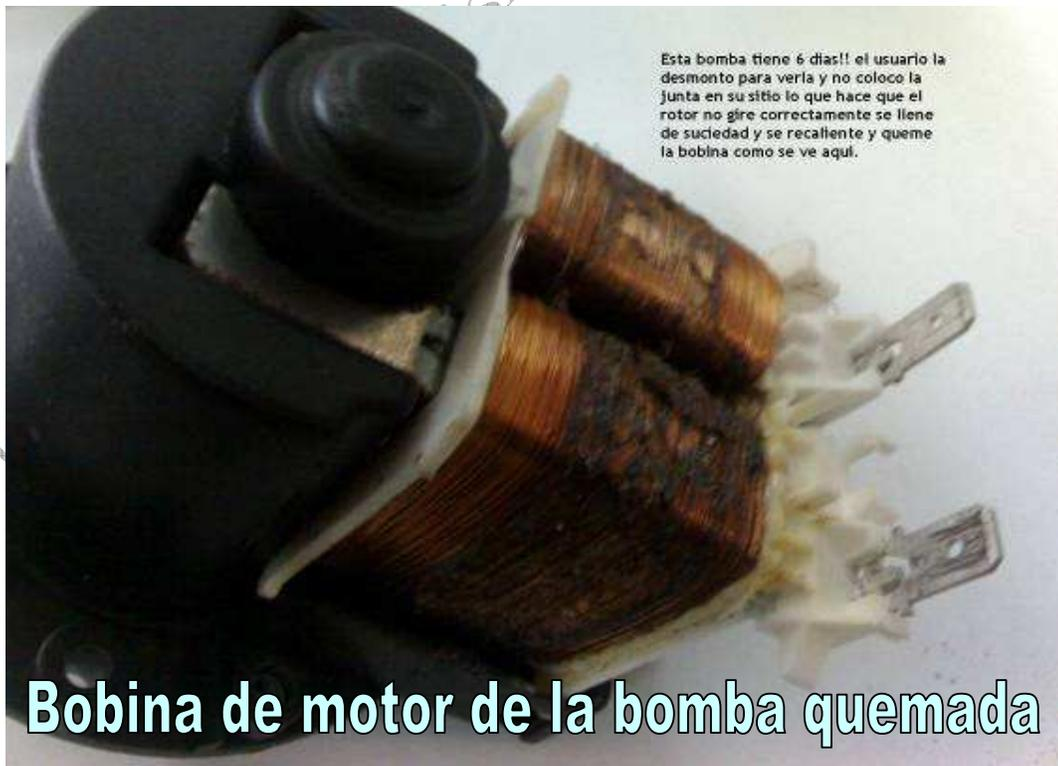
**Recordemos que algunos modelos de lavadora con la bobina de la bomba de agua abierta, se queda muerta, no funcionando ninguna función de la máquina, esto no sucede en LG**
