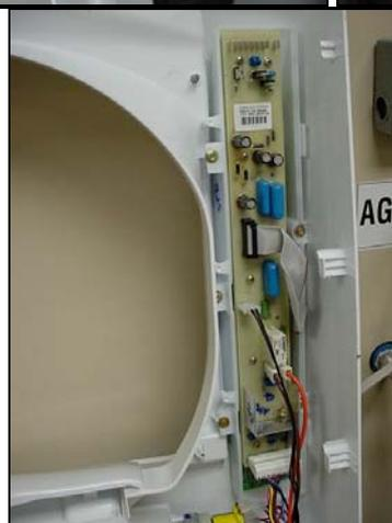
5- Retire os 5 parafusos que fixam o frame do timer na Tampa Fixa.
