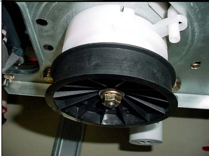
4- Solte a polia e desparafuse o motor com uma chave de  $\frac{1}{2}$  polegada. Desconecte os chicotes: do motor e do Taco Gerador (nome devido à tensão que é gerada por ele).
