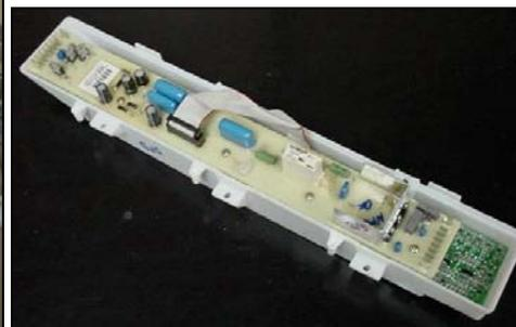
6- Desconecte o "Flat Cable" que liga a Placa de Potência à Placa de interface do produto.
