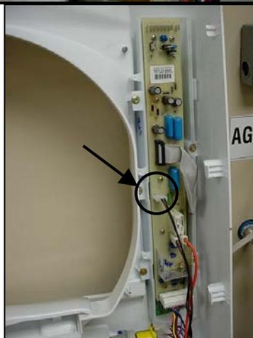
4 – Em seguida programe o produto na função 6<sup>th</sup> Sense, e meça a voltagem no fio do Taco Gerador, deve apresentar 22ACV no mínimo.
