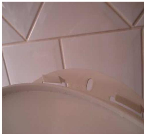
8. Segure pelo varão e force-o para cima, desencaixe a peça branca para baixo e gire-a para que a curva coincida com o rasgo.
