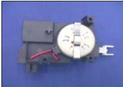
Novo sistema de acionamento de freio, que substitui o solenóide. Este sistema torna a parada do mecanismo mais lenta, não causando os estalos característicos do Solenóide.
