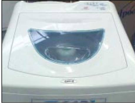
A Tampa Móvel é confeccionada em chapa, com visor em acrílico transparente, permitindo a visualização da roupa no momento da lavagem. Para substituí-la basta retirar os parafusos da sua lateral interna. Observe que a dobradiça da direita possui uma haste, que aciona o Interruptor da Tampa.
