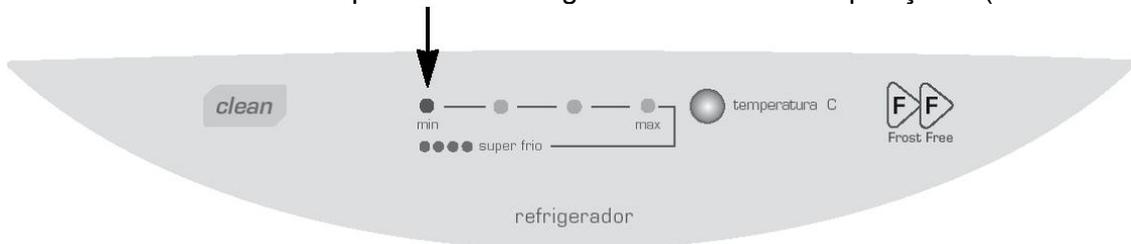
Em condições normais de uso o controle de temperatura do refrigerador deve ficar na posição 2 ou 3 (2° ou 3° led aceso).
