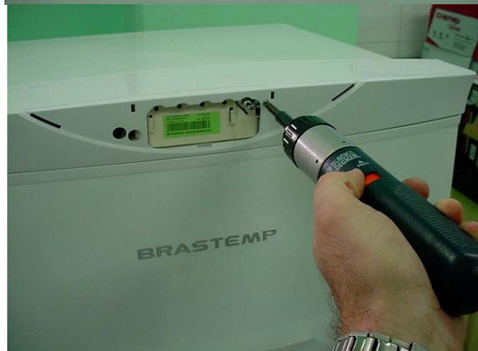
Após soltar o parafuso puxe o console para frente após empurrar as travas laterais como segue na figura.
