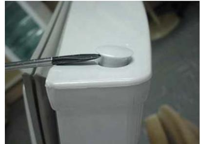
Desparafuse e retire a bucha batente esquerda da porta.
