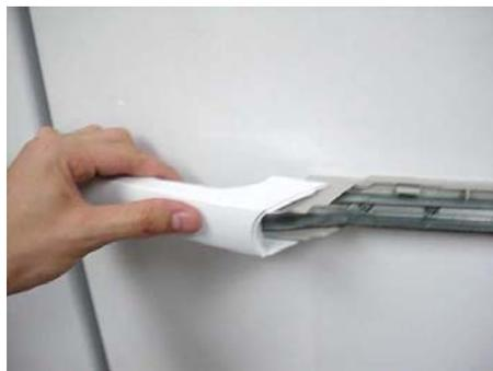
Retire os 4 parafusos que fixam o puxador à porta do produto e desencaixe o reforço metálico.
