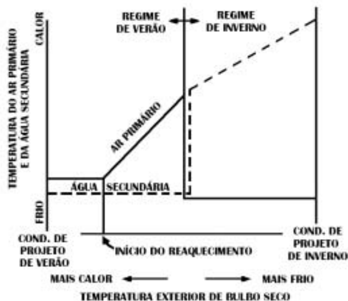
Figura 7.14. Regulagem da temperatura do ar primário de da água secundária.
