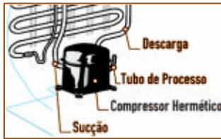
**COMPRESSOR:** sua principal função é succionar o fluido refrigerante a baixa pressão da linha de sucção e comprimí-lo em direção ao condensador a alta pressão e alta temperatura na fase gasosa (*vapor super aquecido*<sup>2</sup>).
