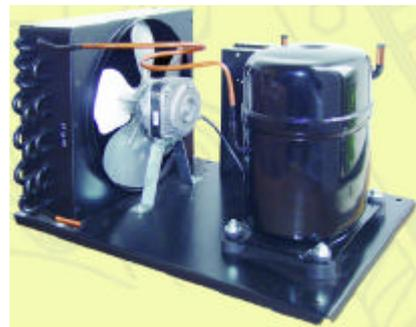
Para um determinado compressor e para uma determinada temperatura do ar de resfriamento que entra no condensador, aumenta-se a pressão de condensação e diminui-se a capacidade frigorífica com a diminuição do tamanho do condensador. Um aumento da temperatura do ar de resfriamento também resulta nos mesmos efeitos acima, para um determinado condensador.
