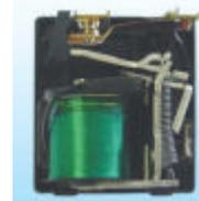
Os relés voltimétricos somente funcionam com capacitores de partida e de fase, pois são utilizados em compressores que necessitam de alto torque de partida e cuja referência comercial que consta dos catálogos dos fabricantes diz acima de 3/4 de HP.
