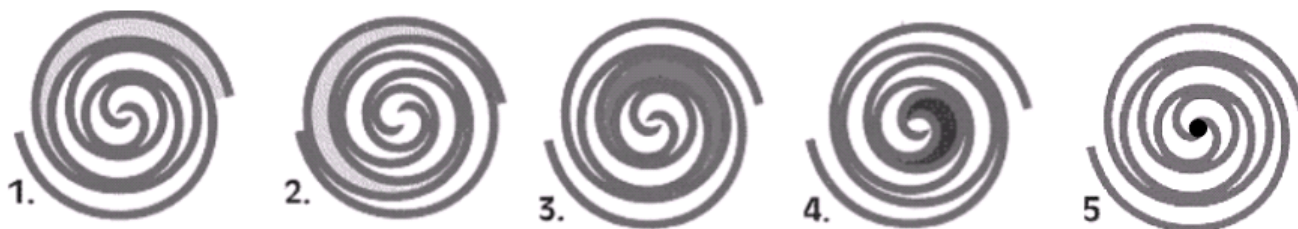
Figura 3.20: Processo de compressão em um compressor Scroll.
