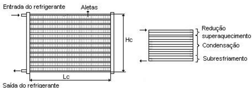
**Figura 3.9** Esquema de um condensador de tubos planos com microcanais e aletas tipo “louver”, com fluxo paralelo, dividido em seções de resfriamento de vapor superaquecido, condensação e subresfriamento.
