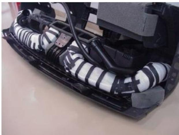
**Figura 6.1** Dutos isolados por uma manta térmica.
