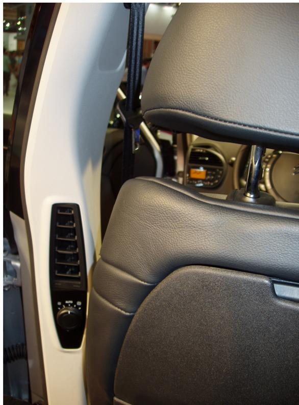
**Figura 3.22** Veículo com difusor posicionado na coluna B.
