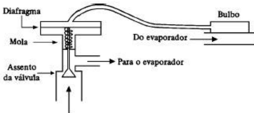
**Figura 3.14** Esquema de funcionamento da válvula termostática.
