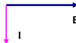
Uma carga puramente capacitiva não realiza trabalho, ou seja, durante meio ciclo da tensão da fonte, o capacitor armazena energia sob a forma de campo elétrico e durante o segundo meio ciclo da tensão ele devolve a energia para a fonte, o que pode ser mais bem compreendido ao se observar à figura abaixo.
